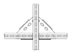
В качестве крестового соединителя, возможно также со сквозным прохождением МРС-профиля
